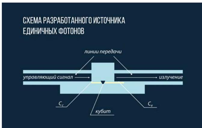
Рис. В.5. Схема разработанного источника единичных фотонов
